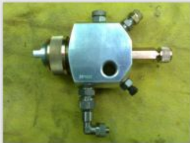
Equipado con regulador de caudal de precision
